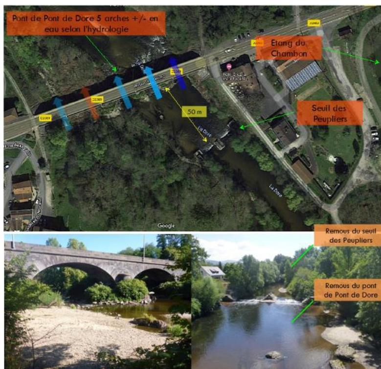
Figure 12 : Photos du contexte hydraulique : pont de Pont de Dore et seuil des Peupliers (Source : Google Map, crédit photo CESAME/S.Saxer (PNRLF))
