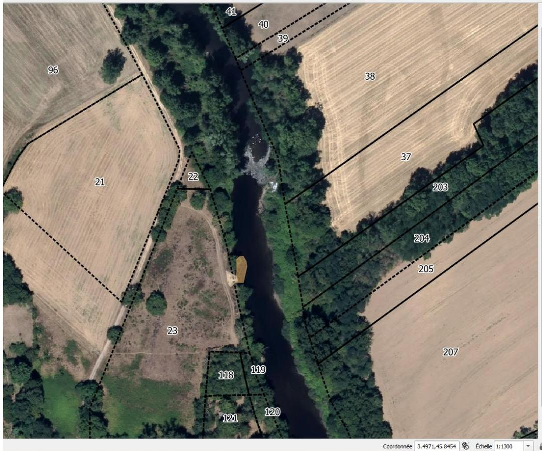
Figure 18 : Vue en plan de l'épis de matériaux réinjectés sur l'encoche de Moëras
